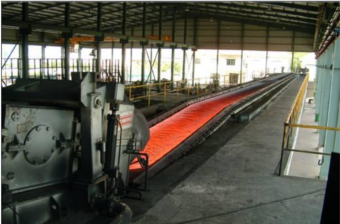
Hình 11: Laying head, máy rải thép cuộn VAI-POMINI
