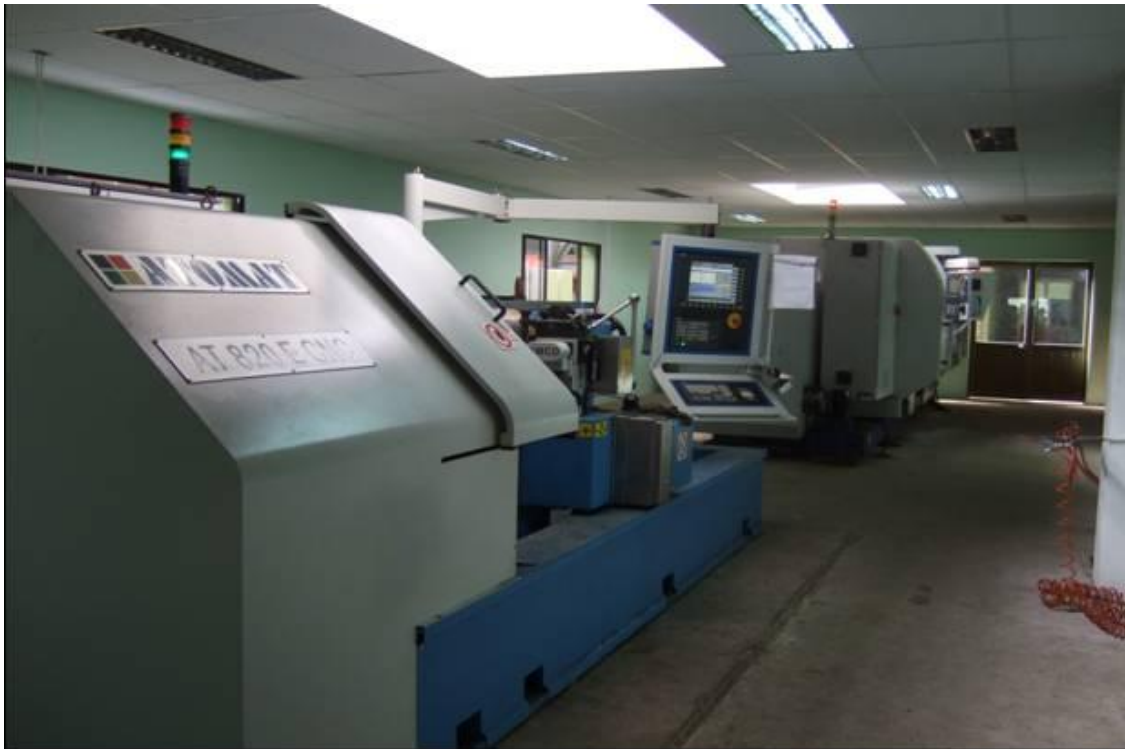
Hình 31: Roll shop với các máy CNC chuẩn bị trực cán
