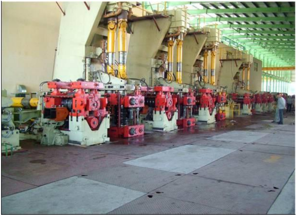
Hình 13: Dây chuyền cán SIMAC (Ý) 300.000 Tấn/ năm
