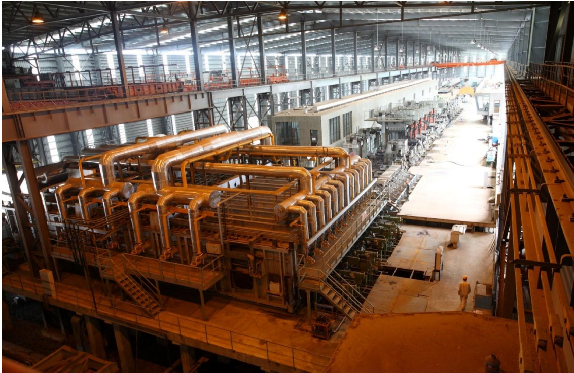
Hình 27: Lò BUỐC 12M hiện đại của Forni Industriali Bendotti
