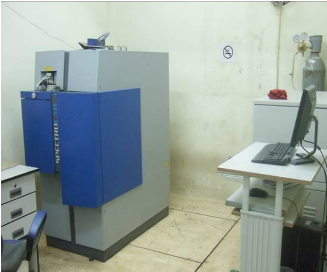
Hình 32: Máy thử thành phần hóa học SPECTRO LAB
