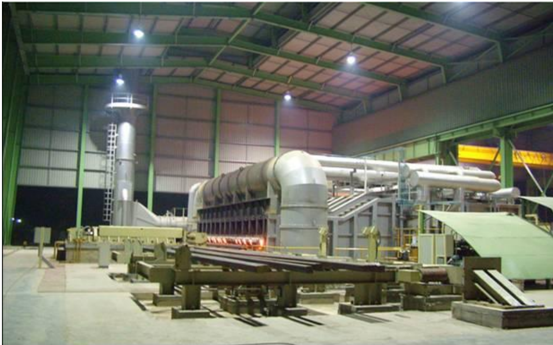
Hình 12: Lò nung theo công nghệ lò đẩy của Forni Industriali Bendotti 12M
