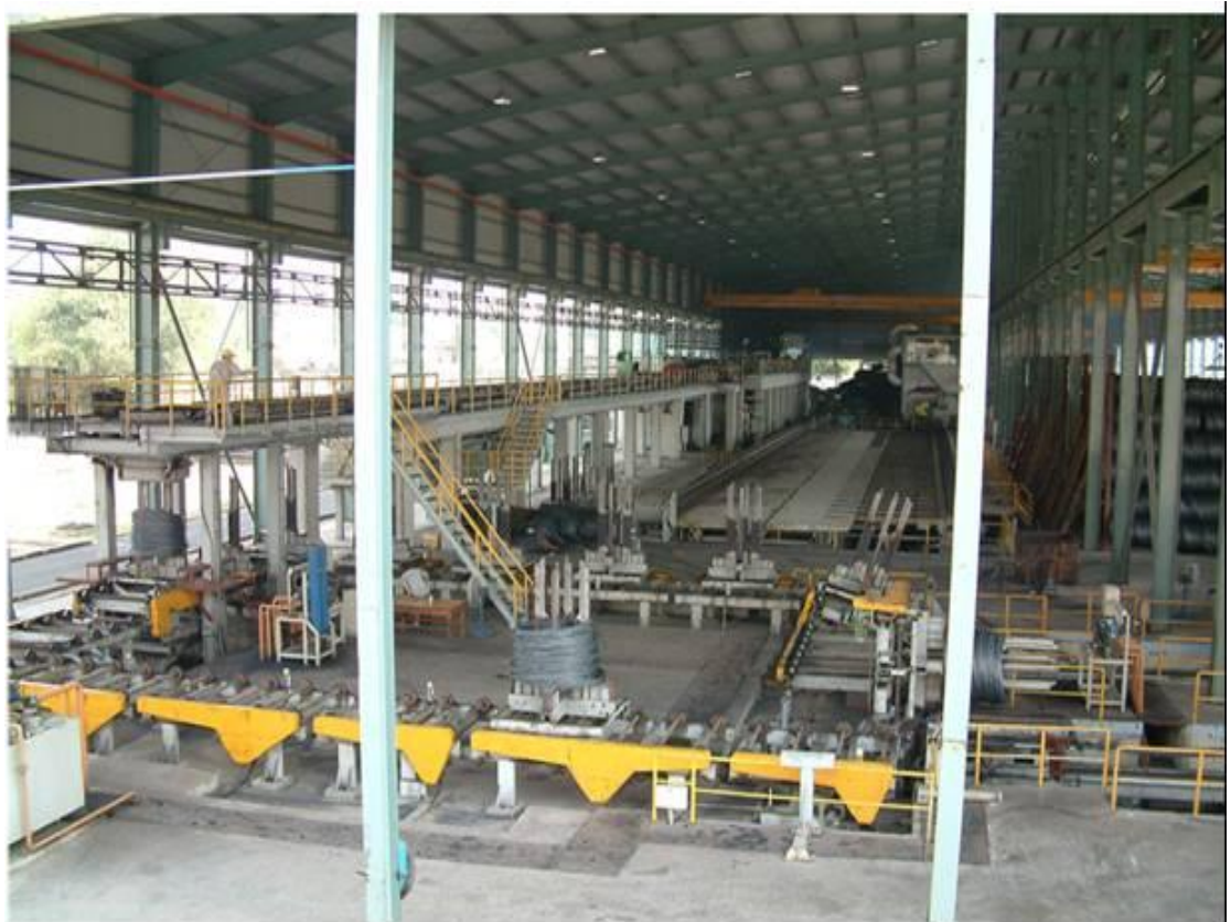
Hình 10: Sàn nguội và Máy bó thép cuộn VAI-POMINI
